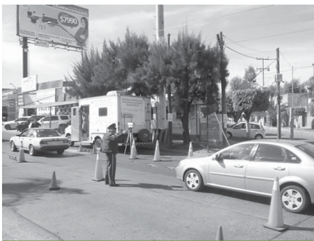
Medición de emisiones con sensor remoto, AMG
