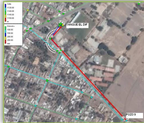
El tanque el DIF es alimentado desde el pozo 9 por medio de una línea de conducción con tubería de acero de 10" de diámetro y cuenta con una longitud de 591 m aproximadamente.
