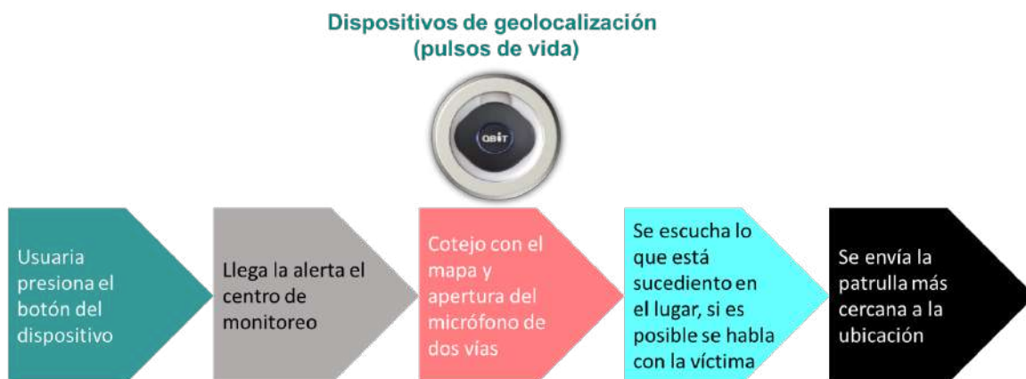
Ilustración 17. Forma general de operar de los dispositivos de geolocalización.
